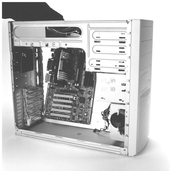
*Рис. 24.13. Установка шасси с системной платой в корпус*
