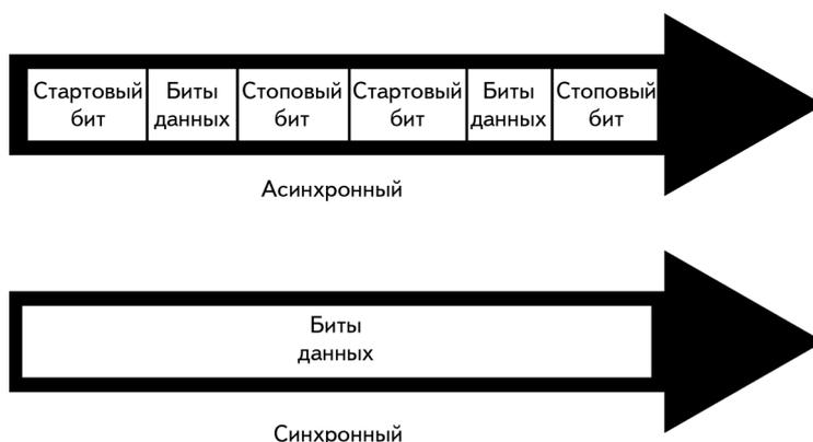
Рис. 18.1. В асинхронных модемах при передаче одного байта данных добавляются стартовые и стоповые биты, а в синхронном соединении данные передаются непрерывным потоком
