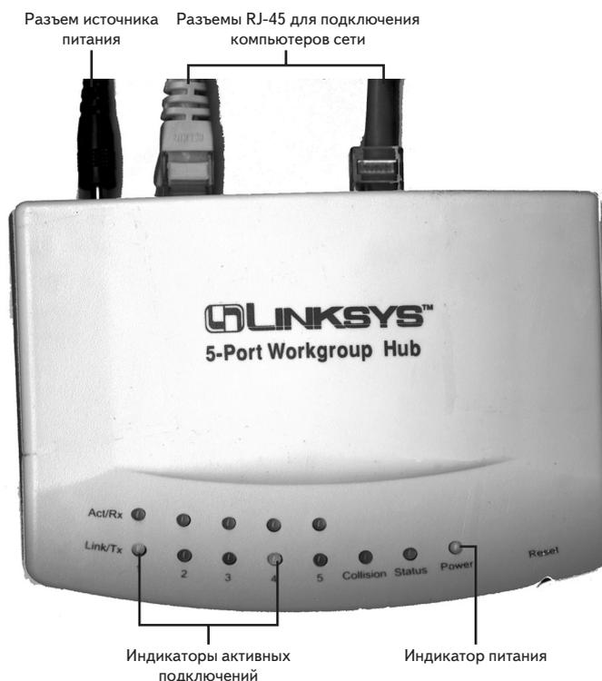
Рис. 19.14. Типичный концентратор 10BaseT на пять портов. Разъемы 1 и 4 подключены к компьютерам (что видно по индикаторам на передней панели концентратора). Индикатор справа показывает, что концентратор подключен к источнику питания
