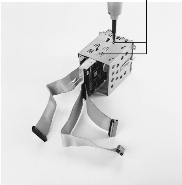
Рис. 24.23. Закрепите жесткий диск и дисковод в съемном отсеке с помощью винтов
