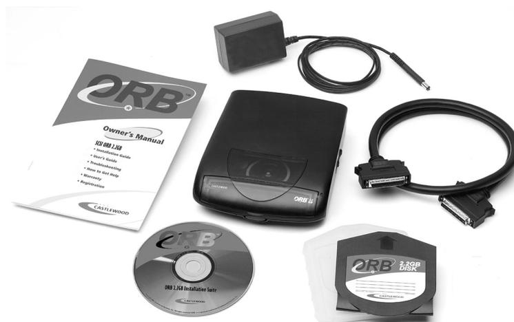
Рис. 12.7. Внешняя SCSI-версия накопителя Castlewood Orb поставляется с кабелем SCSI HD-50, аккумуляторным источником питания, драйверами на компакт-диске, одним носителем и инструкцией. SCSI-адаптер вместе с устройством не поставляется, что впрочем довольно типично для большинства дисководов SCSI
