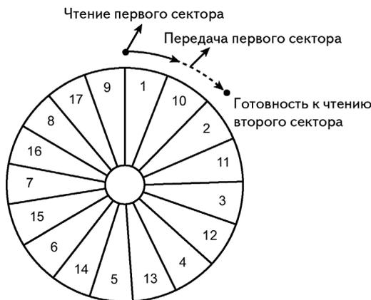
Рис. 10.16. Коэффициент чередования (2:1) соответствует возможностям контроллера
