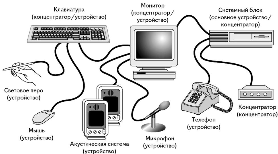
Рис. 16.6. В персональном компьютере может использоваться несколько концентраторов USB для подключения различных периферийных устройств, причем любое устройство можно подсоединить к любому концентратору
