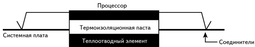
Рис. 23.7. Контакты, соединяющие процессор с платой, находятся на некотором расстоянии от процессора, что позволяет поместить между процессором и платой термоизоляционный материал
