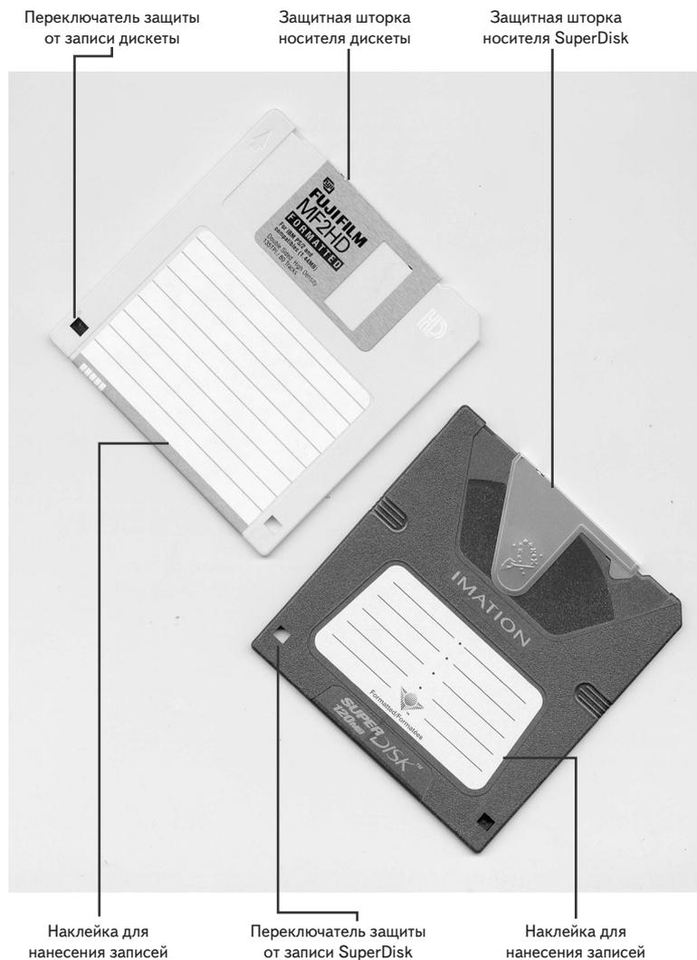
Рис. 12.1. Обычная дискета (вверху) и диск LS-120 SuperDisk (внизу)
