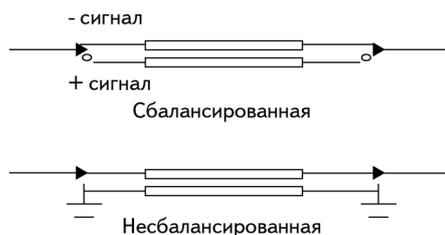
Рис. 8.2. Сбалансированная (дифференциальная) и несбалансированная (однопроводная) шины
