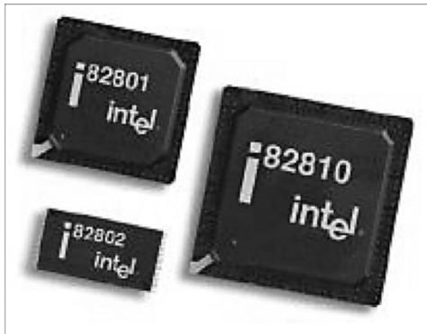
Рис. 4.24. Микросхемы 82810 (GMCH), 82801 (ICH) и 82802 (FWH) набора микросхем системной логики Intel 810. Фото публикуется с разрешения Intel
