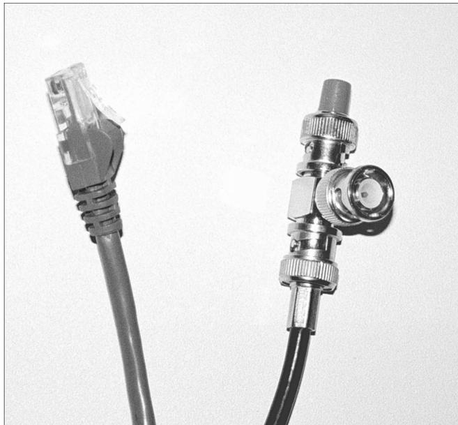
Рис. 19.6. Кабель UTP с подключенным разъемом RJ-45 (слева) и кабель Thin Ethernet с T-образным адаптером BNC и терминатором на нем (справа)
