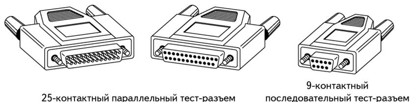
Рис. 25.5. Внешний вид типичных 9- и 25-контактных тест-разъемов
