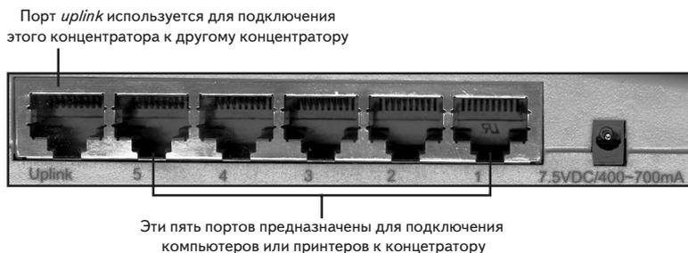
Рис. 19.15. Разъемы типичного 5-портового концентратора для рабочих групп с портом *uplink*, предназначенный для соединения с другими концентраторами (т.е. их объединения). Для объединения концентраторов можно использовать пятый порт либо порт *uplink*
