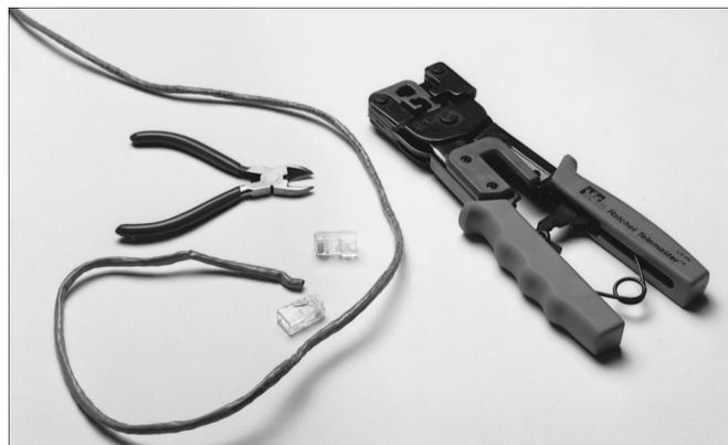
*Рис. 19.17. Для самостоятельного монтажа сетевых кабелей 10BaseT (100BaseTX) понадобятся кусачки, инструмент для насадки, кабель UTP и разъемы RJ-45*
