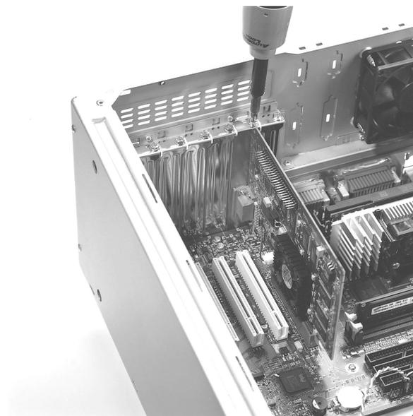
Рис. 24.26. Закрепление адаптера винтом
