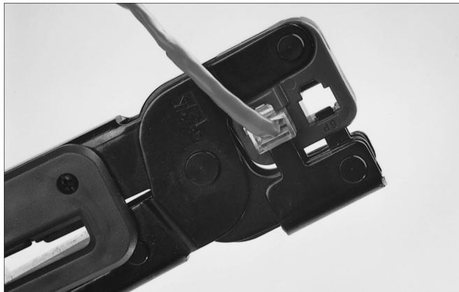
Рис. 19.22. Хорошо сожмите насадочный инструмент, чтобы плотно прикрепить разъем к кабелю
