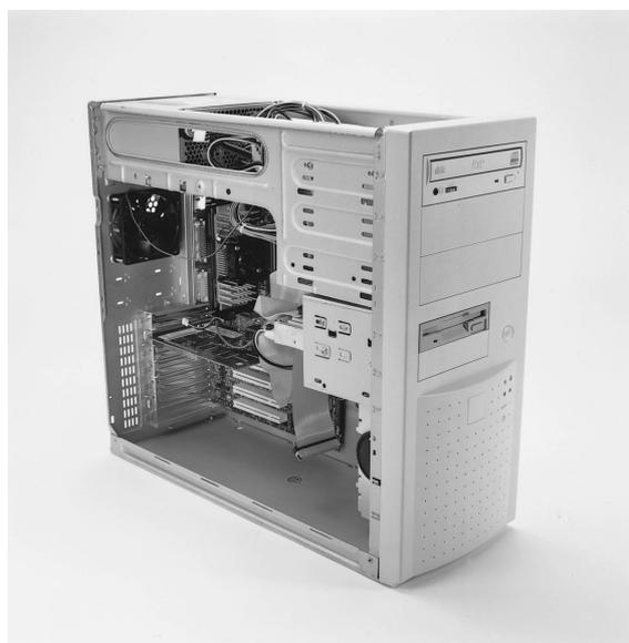
Рис. 24.2. Внешний вид системы, собранной из компонентов, показанных на рис. 24.1
